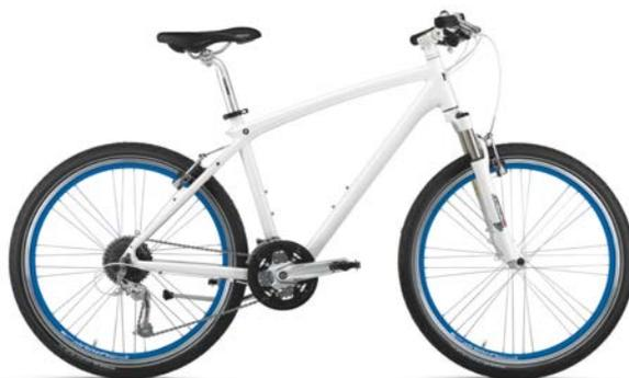
**Масса: (13,2 кг). Алюминиевая рама (AL6061-T6) изготовлена методом гидроформования, с порошковым напылением и сглаженными сварными швами (Smooth Welding).**
