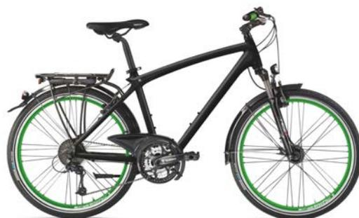
**Масса: 15,5 кг. Алюминиевая рама (AL6061-T6): изготовлена методом гидроформования, с порошковым напылением.**
