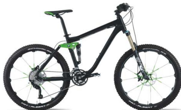
**Масса: 13,4 кг. Алюминиевая рама (AL6061-T6):** изготовлена методом гидроформования, с порошковым напылением. Спортивная настройка ходовой части с блокируемой амортизационной вилкой и четырехшарнирная задняя подвеска с функцией подавления раскачки.
